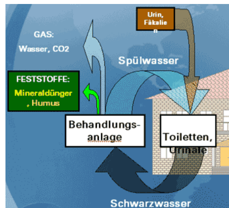
So funktioniert die Anlage der Intaqua AG
